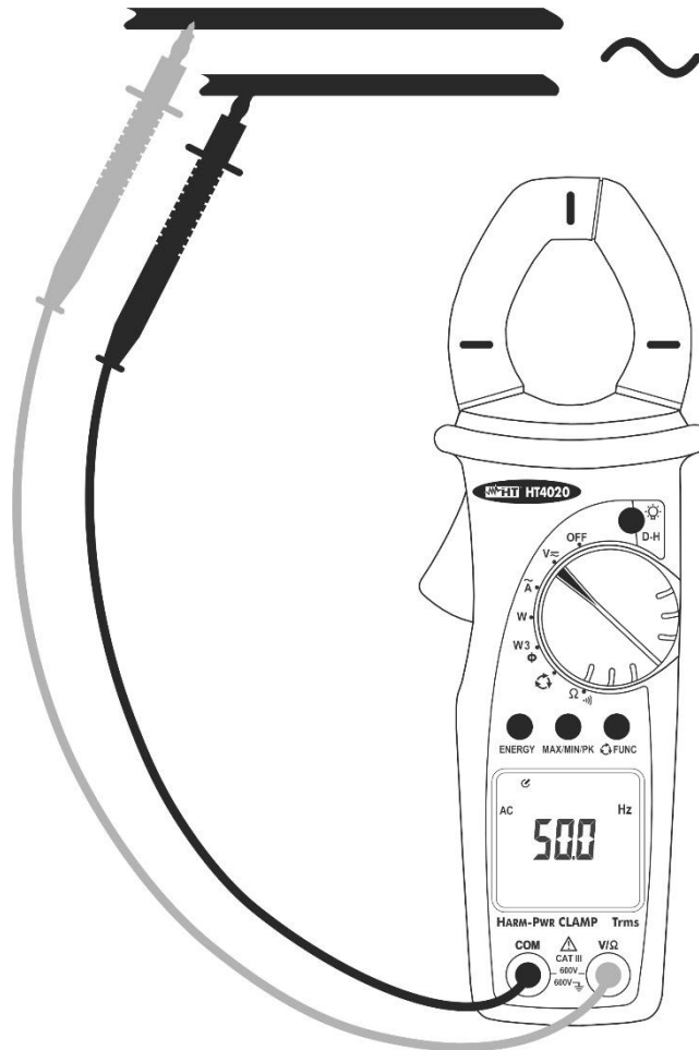
Fig. 5 : Mesure de fréquence de la tension AC
