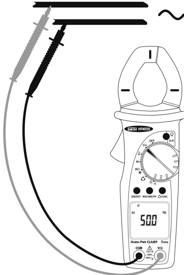
Abb. 5: Frequenzmessung mit Messleitungen
