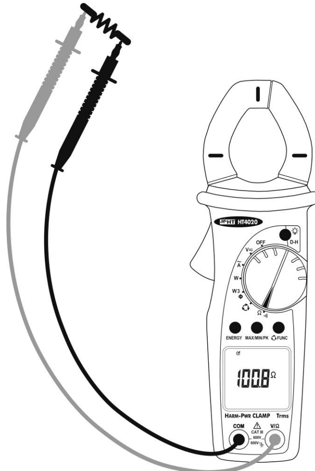
Abb. 7: Widerstandsmessung und Durchgangstest
