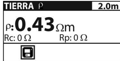
Fig. 29: Pantalla final medida resistividad del terreno
