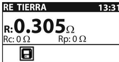
Fig. 26: Pantalla final medida resistencia de tierra
