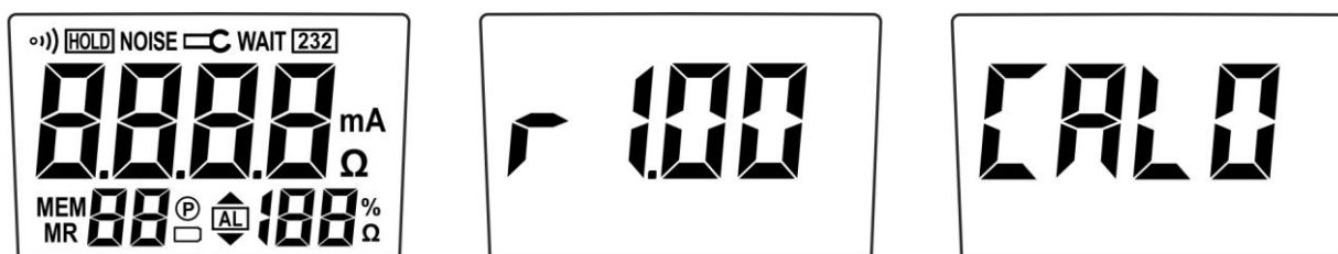
Fig. 3: Séquence affichée au démarrage de l'instrument
