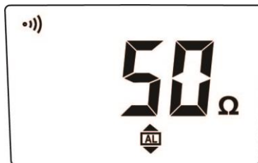
Fig. 33: Impostazione soglie di allarme per misura di resistenza
