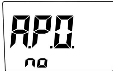
Fig. 36: Desativação da função Desligar Automático (Auto Power OFF)
