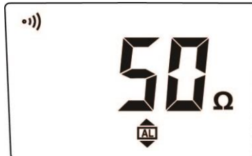
Fig. 33: Configuración umbrales de alarma para la medida de resistencia
