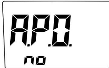
Fig. 36: Deshabilitación función Autoapagado
