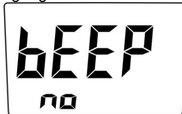
Abb. 37: Deaktivierung der Funktion Tastenton
