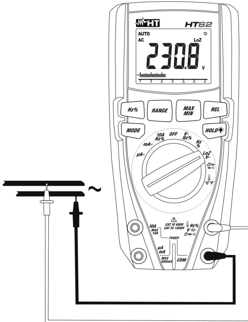
Fig. 4: Uso del instrumento para medida de Tensión CA/CC con función LoZ
