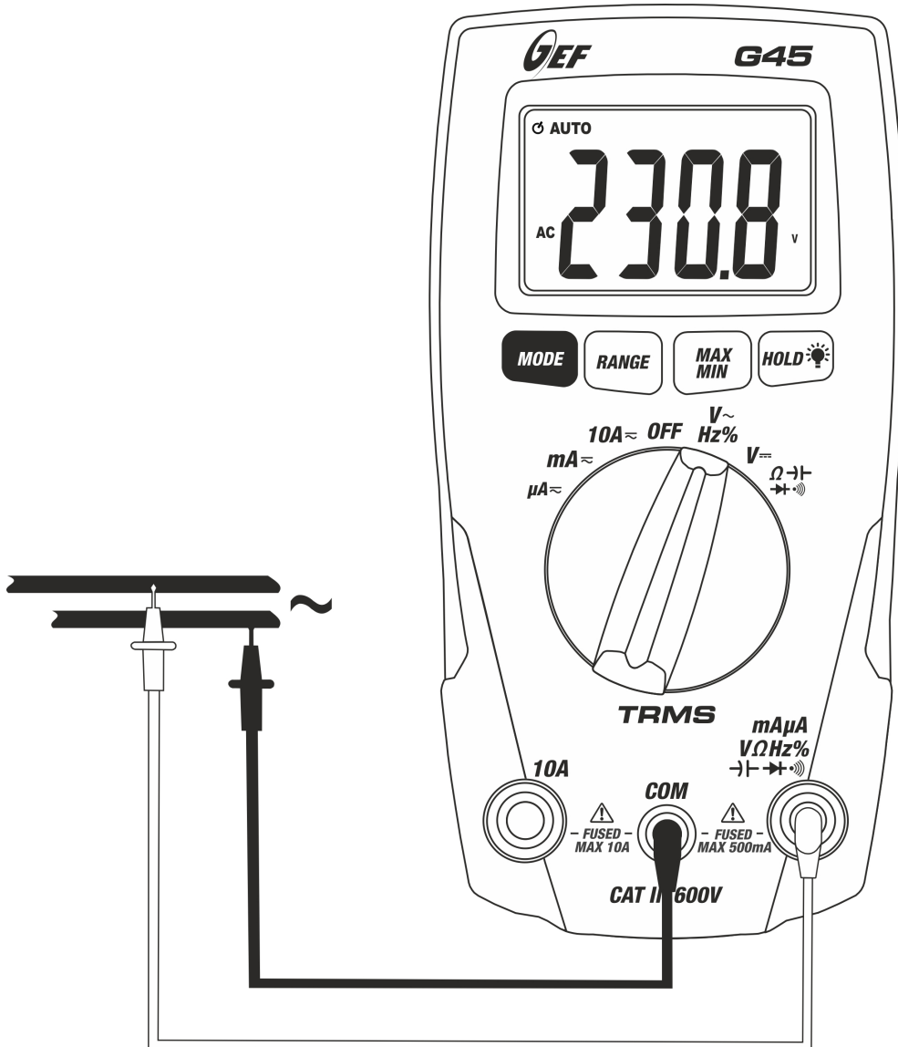
Fig. 3: Uso del Instrumento en medidas de Tensión CA
